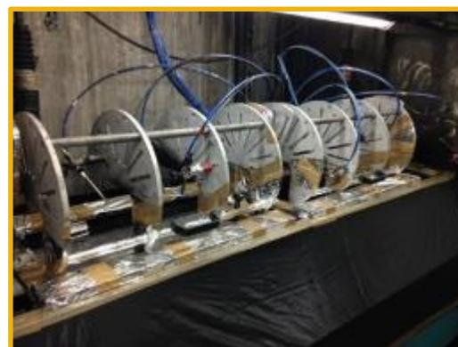
film di alluminio e polietilene per ridurre al minimo i tempi di pulizia soluzionatrice / cabina verniciatura
